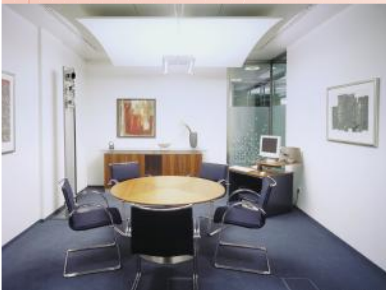
Akustik-Deckensegel mit integrierter Direkt-/Indirektbeleuchtung in einem Beraterraum der Kreissparkasse in Dorsten
