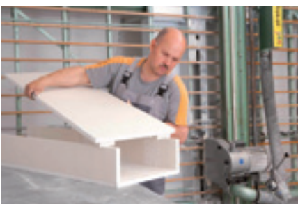
Vorfertigung eines Brandschutzkabelkanals
