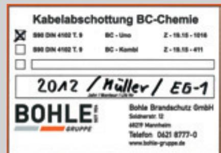
Bauaufsichtliche Kennzeichnung für eine Kabelabschottung
