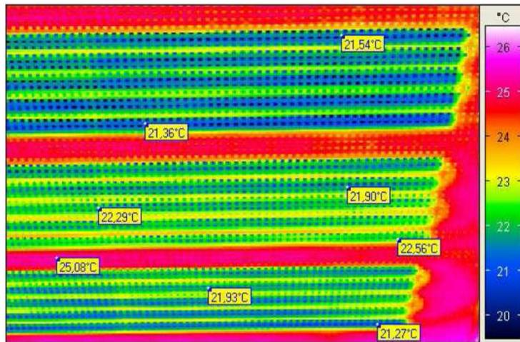
[Abb.15] Wärmebildaufnahmen können die ordnungsgemäße Funktion der Kühl- bzw. Heizdecke dokumentieren (hier: Kühlsystem Bohle/GKTL-Cu)
