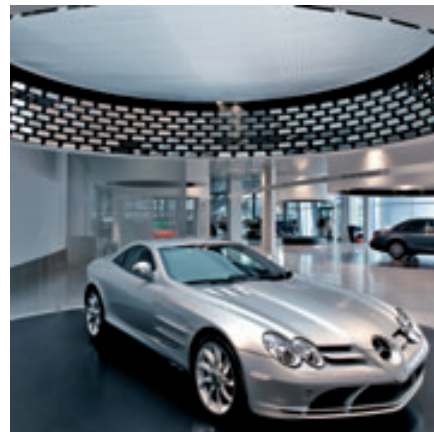
Deckensegel mit Edelstahlvlies-Bespannung und umlaufender Schürzenverkleidung, dekoriert mit den Außenspiegeln des ausgestellten Sportwagens
