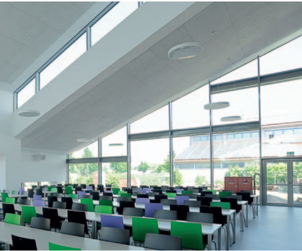
Mensa Hannah-Arendt-Gymnasium – Aluminium-Pfosten-Riegel-Konstruktion und Sonnenschutz-Raffstoreanlagen
