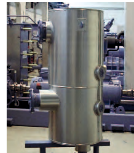
PUR-Schaumdämmung mit Blechummantelung an einem Kühlwasseraggregat
